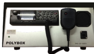
Fig. 14: Stazione fissa Polybox con TPM700. Esempio cantone Vales.
