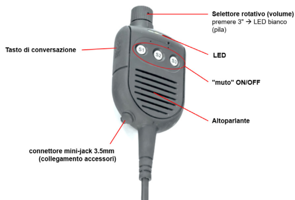
Fig. 21: Componenti del monofono.
