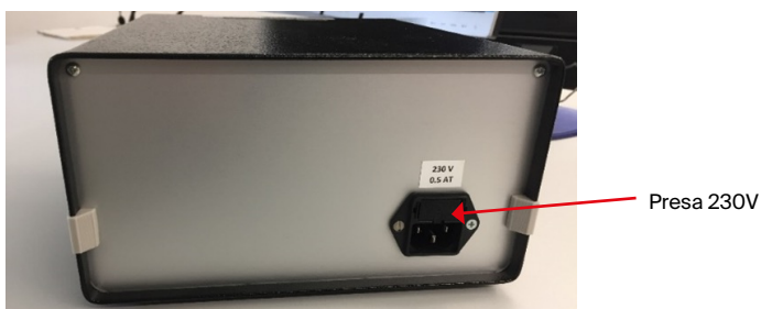
Fig. 63: Presa del modem Master NAG (parte posteriore).
