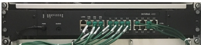
Fig. 42: parte frontale Mitel 430 con porte per raccordi esterni.
