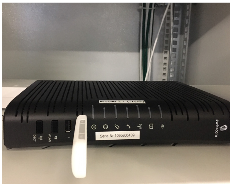
Fig. 44: modem/router SBCON Centro Business 2.0 Swiss con stick USB per 4G LTE.
