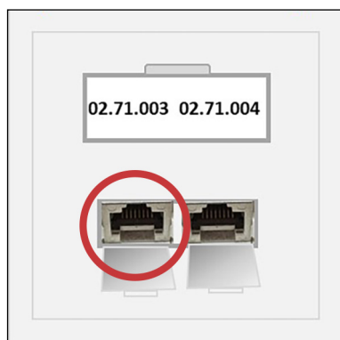
Fig. 47: scatola di raccordo con numerazione specifica (nell'esempio: scatola di raccordo 3 nel centro telematica).
